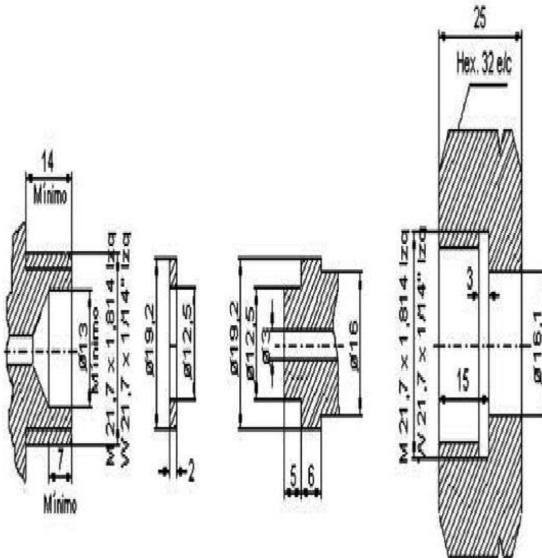
ACOPLAMIENTO M.21,7 x 1,814 MÉTRICO (IZQUIERDAS).
