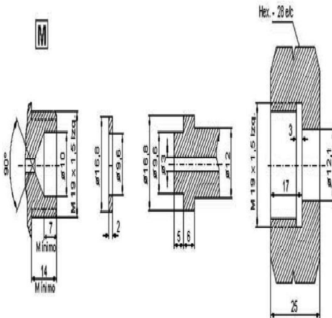
ACOPLAMIENTO M 19 x 1,5 MÉTRICO (IZQUIERDAS).
